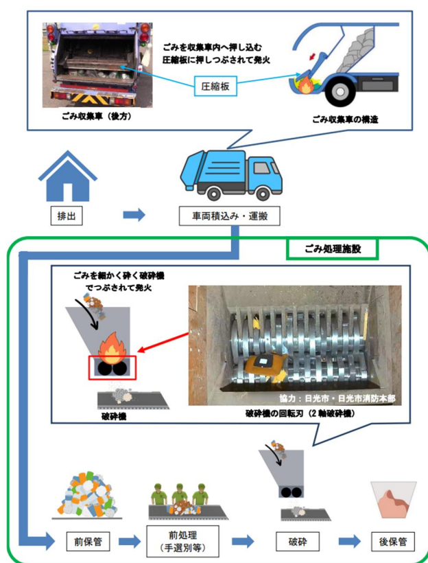
図 18 ごみ処理の工程
